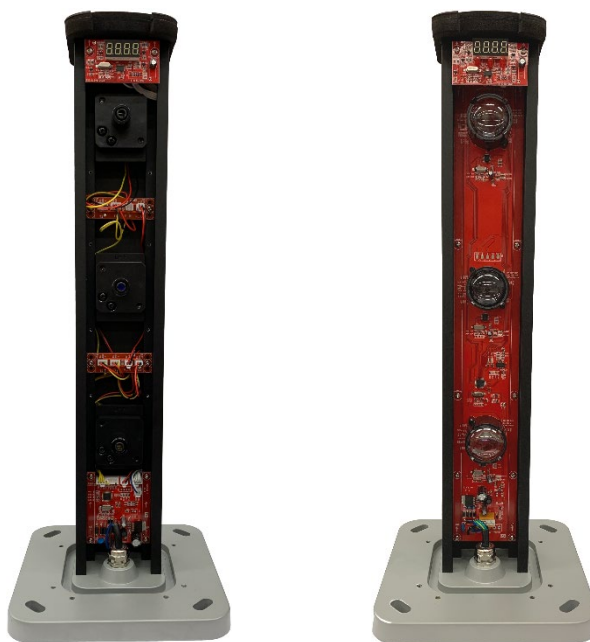
Érzékelő pár belső felépítése
